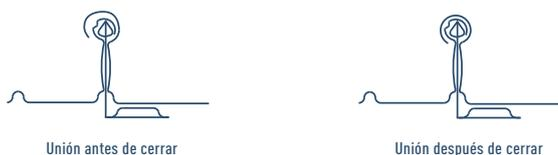
Las bandejas van aseguradas a la estructura mediante clips de anclaje, diseñados para permitir el movimiento causado por la dilatación térmica, pudiéndose usar chapas de mayor longitud. Las bandejas se fabrican a medida para cada proyecto. Las longitudes están solo condicionados por el transporte.
